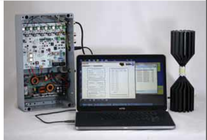
Μονάδα Ελέγχου Γενικής Χρήσης, Φωτιστική Πηγή και εξωτερικός υπολογιστής με λογισμικό εργαλείο διαμόρφωσης παραμέτρων
